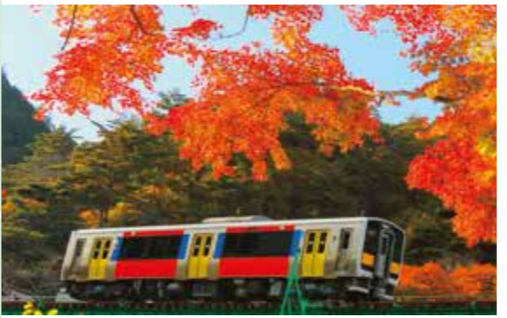
水郡線を走る鮮やかボディのキハE130系は電車ではなくディーゼルエンジンで走る気動車。ゴトゴトとリズムカルに揺れ進む心地よさはローカル線の醍醐味！
